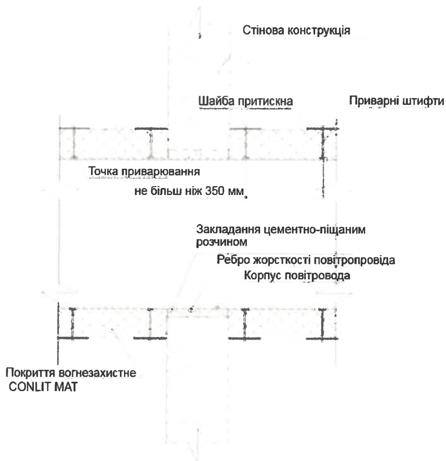
Мал. 5. Принципова схема перетину повітропроводом будівельної конструкції
