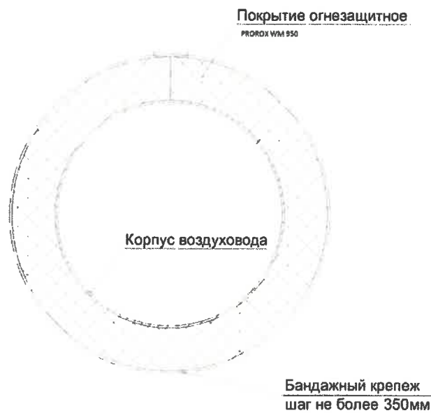
Мал. 1 а, б, в Монтаж системи за допомогою бандажного кріплення
